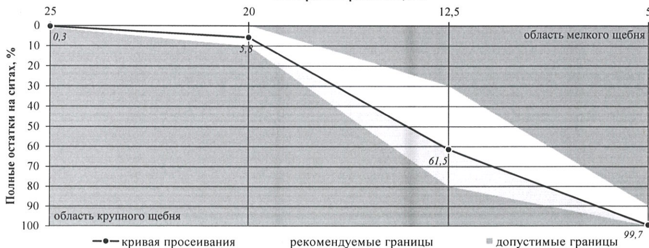
Кривая просеивания щебня Размеры отверстий сит, мм
